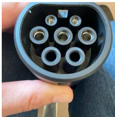
Type 2-stikket, som sættes i bilens Type 2-port.
